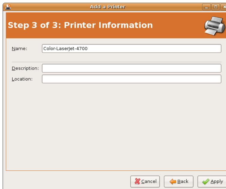
Gambar diatas menunjukkan anda telah selesai melakukan konfigurasi, klik apply maka di box add printer akan muncul printer yang anda pilih tadi. Selanjutnya untuk mengetest apakah printer anda berjalan baik di Linux atau tidak, **klik kanan pada printer -> pilih Jobs.**
