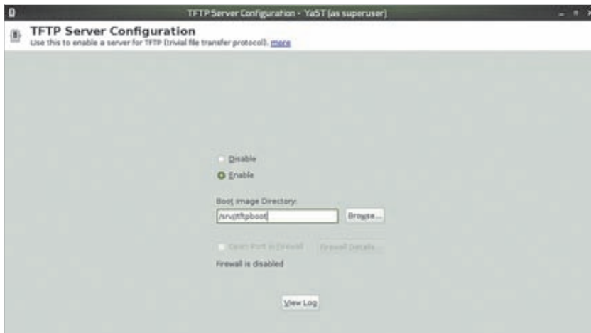
Konfigurasi server Tftp dengan menggunakan YaST.
