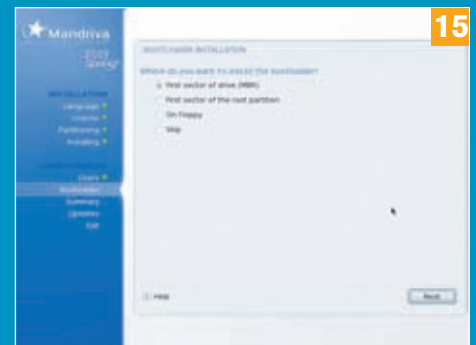
Pilih opsi untuk menginstalasikan Grub bootloader ke MBR.
