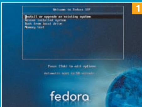
Pilih option install/upgrade untuk memulai proses instalasi.
